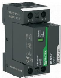
Комбінація ПЗІП на основі варистора та захищеного модульного іскрового розрядника, об'єднані за схемою 1+1 (3+1). Для низьковольтних установок на межі зон LPZ2 та LPZ3. Для захисту обладнання та приладів від індукованої перенапруги, а також від комутаційних перенапруг. Встановлюється якомога ближче до обладнання, що необхідно захистити.
