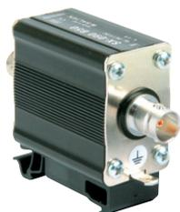
Тонкий захист від перенапруг коаксіальних входів телевізора та систем відеонагляду від імпульсних перенапруг. Встановлюється як другий рівень захисту від перенапруг в координації з типом FX. Встановлюються біля обладнання, що захищаємо.
