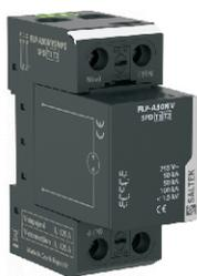
Іскровий розрядник між N та PE зі змінним модулем, призначений для використання в низьковольтних установках на межі зон LPZ0 та LPZ1. Захист від перенапруги у випадку прямого попадання блискавки, а також індукованої перенапруги.
