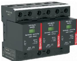
Блискавкозахист дуже великої потужності, призначений для використання в низьковольтних установках на межі зон LPZ0 та LPZ1 або вище. Захист від перенапруги у випадку прямого попадання блискавки, а також індукованої перенапруги. Для використання в різноманітних установках; офісних, виробничих будівлях або в розподільчих щитах великих будівель.
