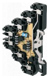
Захист від перенапруг для одно- та двожильних ліній. Для захисту телекомунікаційних, вимірювальних, сигнальних ліній та комунікаційних інтерфейсів I&C, електронних систем охоронної та пожежної сигналізації. Встановлюються біля обладнання, що захищаємо.
